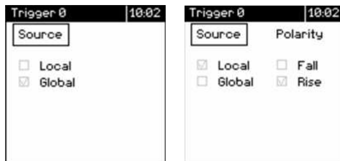
Rys. 42. Ustawienia wejścia wyzwalającego dla trybu Strobe
